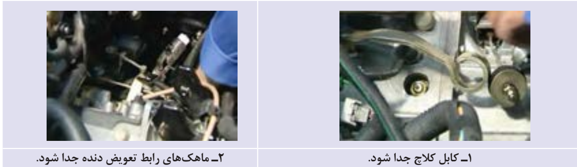
شکل ۹-۱۰- جدا نمودن اتصالات سیستم تعویض دنده
